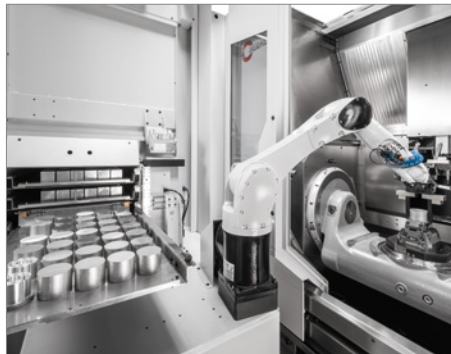
Greifer eines Robotersystems RS 05-2
