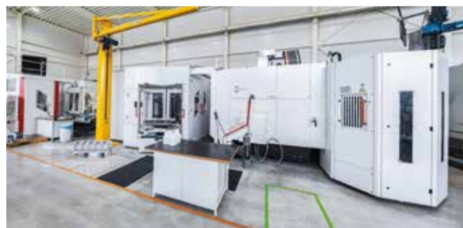
oben Neun Meter Hallenhöhe lassen die C 650 U mit HS flex heavy-Automation fast klein wirken, im Hintergrund steht die roboterautomatisierte C 30 U.
