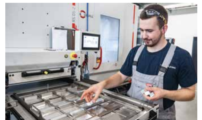
oben Fadri Pitsch bestückt die Matrizen mit Rohlingen und verschafft der C 12 U genug Arbeit für die nächste personenlose Schicht.
