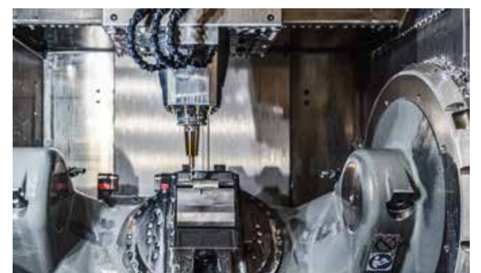
oben Hamilton ersetzte drei Stand-alone-Maschinen durch zwei effizientere Hermle-Anlagen mit Automation. Dabei war ein automatisierter Schraubstock Pflicht.
