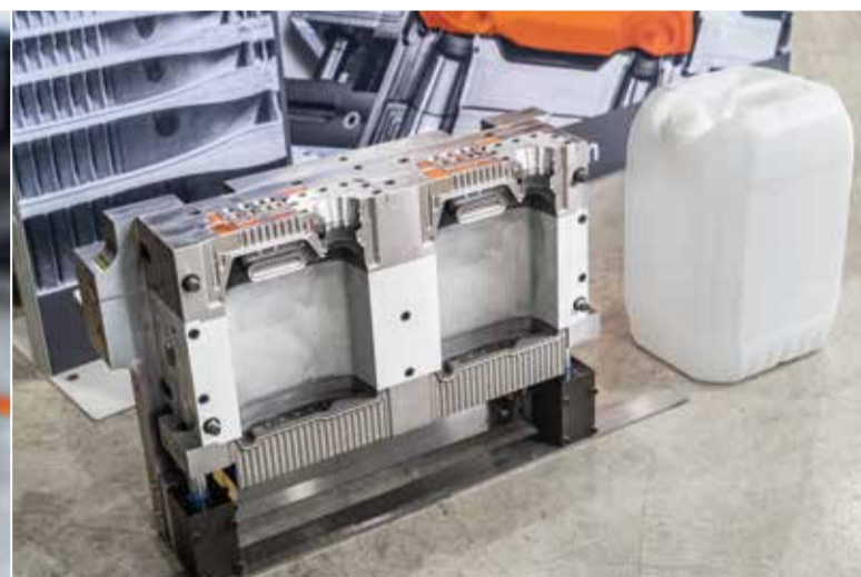
links Durch die präzise Bearbeitung der Passungen spart Blomix später in der Montage Zeit ein. rechts Die Formwerkzeuge von Blomix kommen überall dort zum Einsatz, wo aus thermoplastischem Kunststoff Behälter für Lebensmittel, Haushalt und Industrie entstehen.
