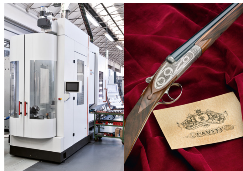
links Frontansicht des Rüstplatzes vom Palettenmagazin- und Wechselsystem PW 150, das an das Bearbeitungszentrum C 22 U angedockt ist rechts Doppelflinte mit Seitenschlösser Modell Senator Kaliber 28
