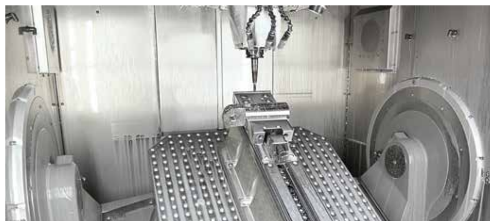
Der große Arbeitsbereich (1.000 x 1.100 x 700 mm, X-Y-Z) des 5-Achsen-BAZ's C50UP und der NC-Schwenkrundtisch mit 700 mm Durchmesser für Paletten 800 x 800 mm zur Aufnahme von Werkstücken mit einem Gewicht bis 2.000 kg.
