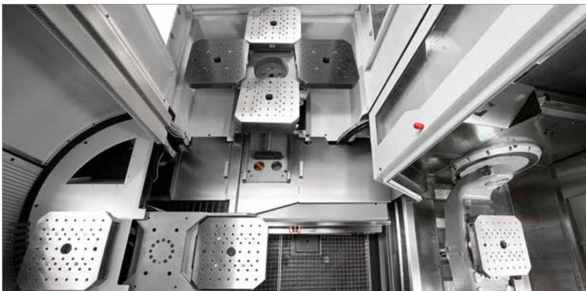
Blick in einen Palettenwechsler PW 250 mit Rüstplatz (links), 4-fach Speicher (hinten), der Verfahreinheit (vorne) und des Maschinen-Arbeitsraums (rechts).
