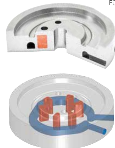
Werkzeugeinsatz mit integrierten Kupferkernen. Die generative Fertigung mit zwei Materialien ermöglicht die kombinierte Wärmeabfuhr über Kühlkanal und Kupferkerne. Materialien: Warmarbeitsstahl 1.2344 und Reinkupfer.
