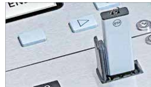
2 Speichermedien können über die USB-2.0-Schnittstelle unkompliziert und schnell am Bedienpult angeschlossen werden.
