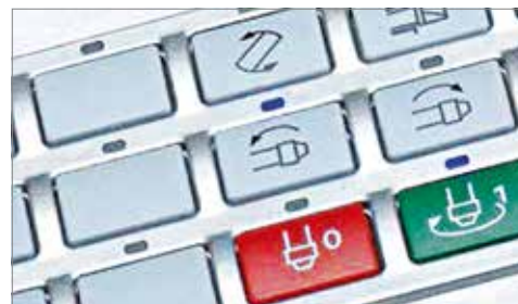
1 Die Tasten sind angenehm und leicht zu bedienen. Leuchtdioden informieren über aktivierte Maschinenfunktionen.
