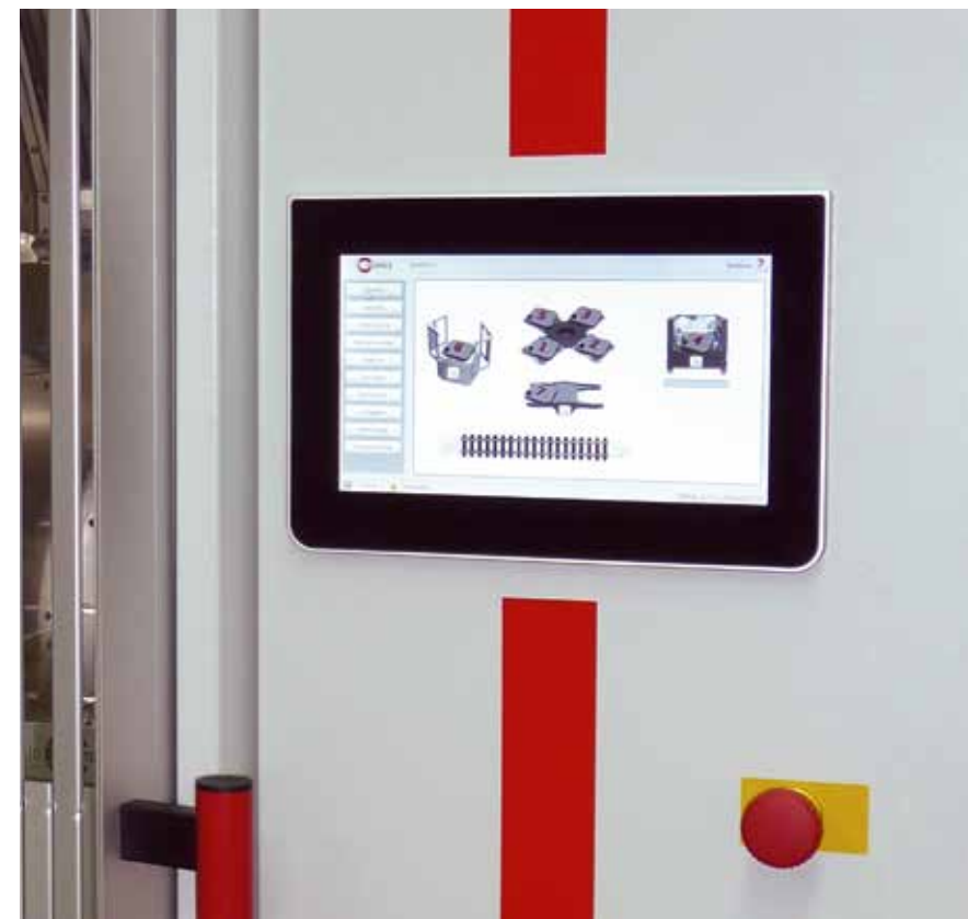
Das zusätzliche Bedienpanel – adaptiert am Palettenwechsler-Rüstplatz.
